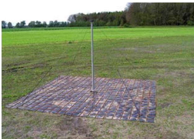
En enda LBA-antenn. Den är ungefär 1,5 meter hög.
