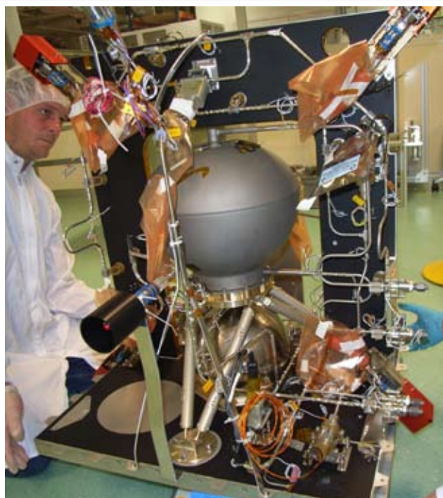
Lars Axenfolk ses här väga in en del av Prismas satellit Main. Den övre behållaren kommer att fyllas med det vådliga hydrazinet, medan den undre kommer att bära med sig det nya miljövänliga HPGP-bränslet.
