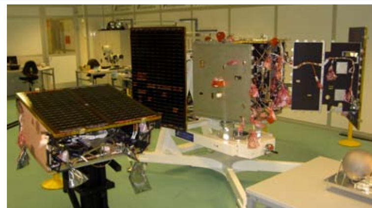
Primasatelliterna med monterade solceller: Target (närmast i bild) och Main.
